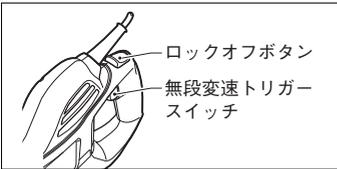
本機には無段変速トリガースイッチが装備されており、トリガースイッチの引き加減で変速します。切り始めと切り終り時のストローク数や切断速度をゆっくりすることで安全に作業をすることが出来ます。
