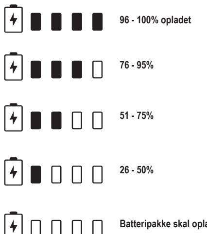
**Bemærk:** LED-lampen for opladningstilstand vises kun, når der trykkes på knappen for opladningstilstand.
